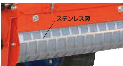
回転式散布量調節ロール (ステンレスの四角い溝付)
