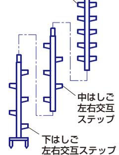
写真はWR-45 最大使用荷重 100kg
