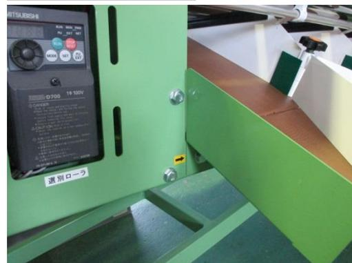
・矢印ボルトを 3 本取りはずし、そのボルトで固定する。
