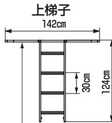
注) 安全のためロープフックを利用して梯子とハウスのパイプをロープで固定してください。
