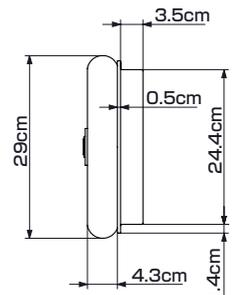
ボス幅 約8.8cm 適合シャフト径 φ20 重量 1.07kg
