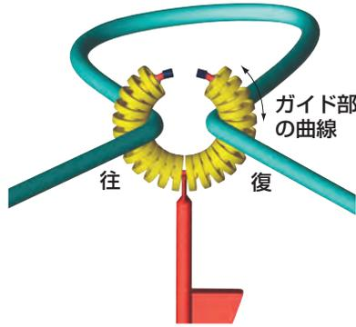
●ガイド部の曲線は、ホースがはずれにくく、あらゆる方向からのホースの通過をスムーズにします。さらにガイド部の付け根部が固定ですから、ホースの往復通過が可能です。
