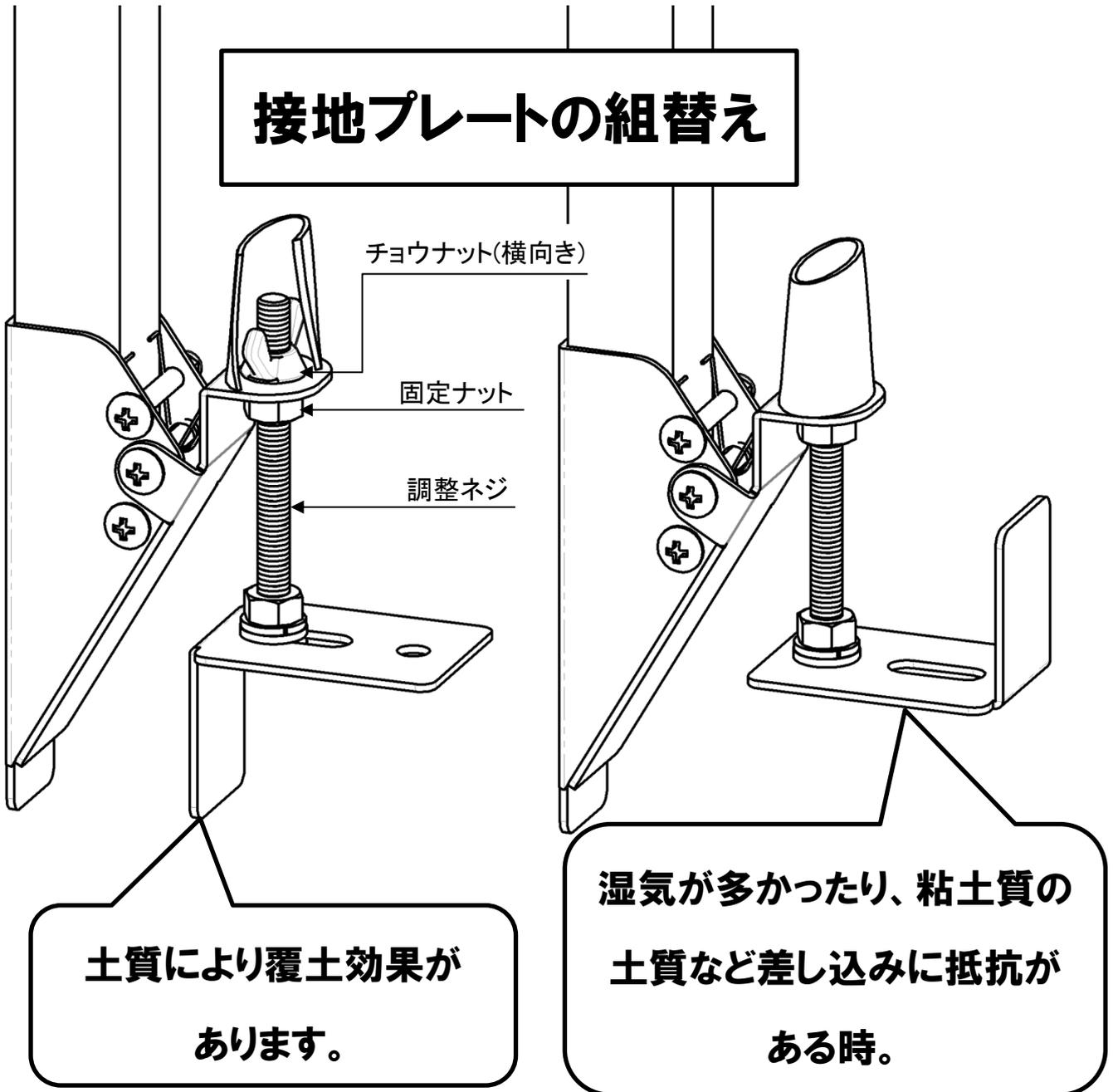
チョウナットをゆるめて、接地プレートの高さを変えると、播種の深さ調整ができます。チョウナットは横向きにして下側の固定ナットで締めます。
