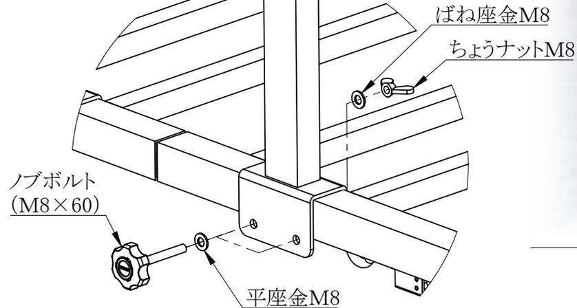
●使用状態=お使いのトンネル支柱のサイズに合わせて、架台を調整してください。
