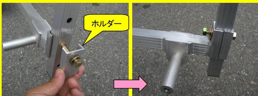
サイドフレームをタイヤフレームとホルダーではさみ込んでボルトで固定します。(高さは3段階調節できます。) M8×45六角ボルト使用
