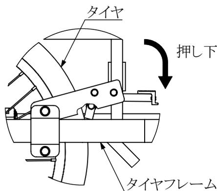
①ヘムロック本体をコンパクトのタイヤフレームにブレーキサドルとボルト類を使用して仮止めし、ブレーキレバーを押し下げてロック状態にし、ヘムロックをスライドさせタイヤへ押し当てます。
