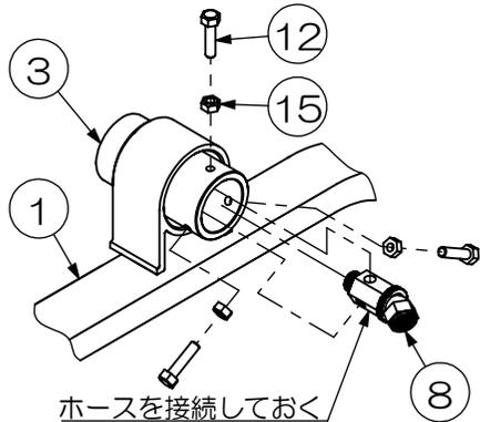
あらかじめ、⑫ボルトの根元まで⑮ナットを入れておき、3方向から⑧より戻し金具を均等に締め付けて固定する。その後、⑫ボルトがゆるまないように⑮ナットを締めてロックする。
