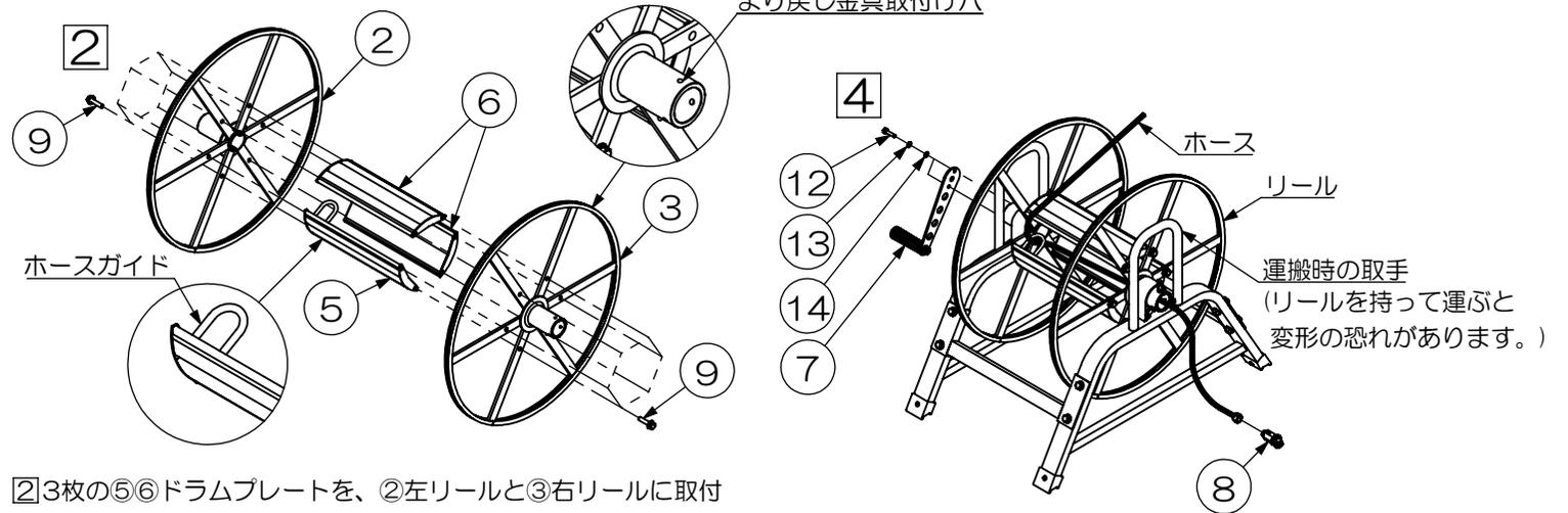
②3枚の⑤⑥ドラムプレート(⑤ドラムプレート(ホースガイド付)はホースガイド側を、②左リールに組付けてください。(より戻し金具取付け穴のある、③右リールの反対側にホースガイドが付く。)
