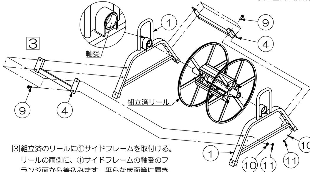
③組立済のリールに①サイドフレームを取付ける。リールの両側に、①サイドフレームの軸受のフランジ面から差込みます。平らな床面等に置き、①サイドフレームの4本の脚が接地するように確認しながら④ツナギパイプを組付けてください。
