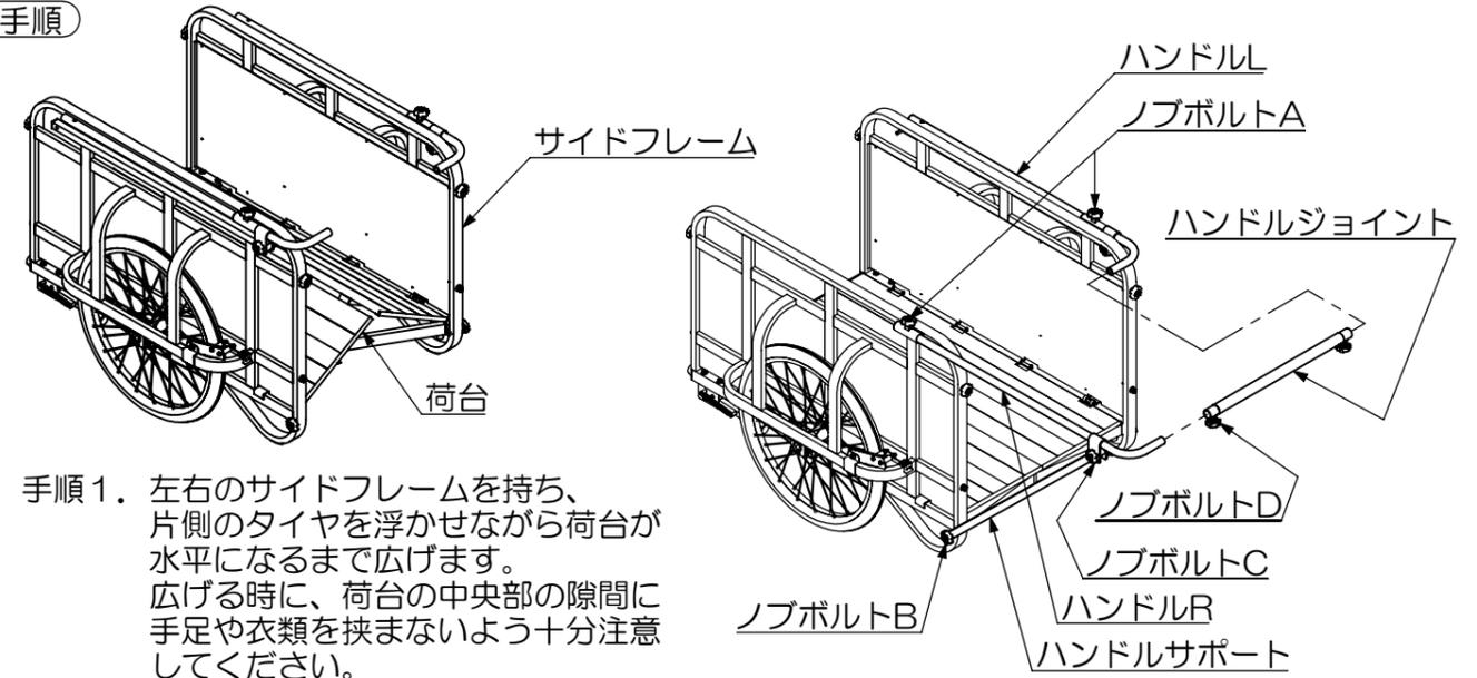
手順1. 左右のサイドフレームを持ち、片側のタイヤを浮かせながら荷台が水平になるまで広げます。広げる時に、荷台の中央部の隙間に手足や衣類を挟まないよう十分注意してください。
