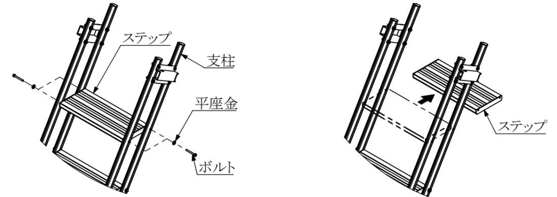
1. 最上段のステップと支柱を固定しているボルト、ナットを外します。(各4個)
