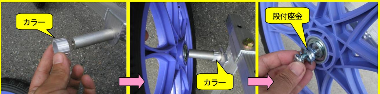
タイヤフレームのシャフトにタイヤカラーを入れます。次にタイヤを差し込んで、段付座金とばね座金を入れてボルトで固定します。 M8×25ナベ小ネジ使用
