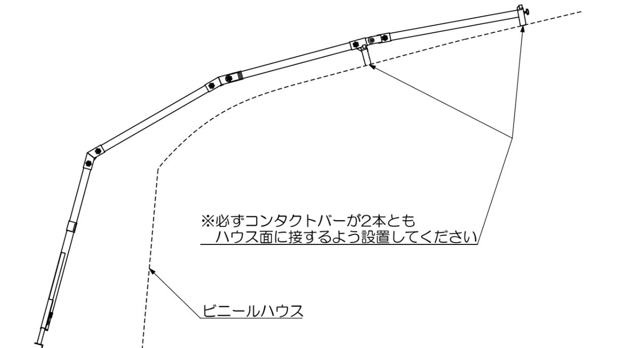
※設置する時や移動する時は付属している固定ベルトなどで図のように上梯子とロープフックを固定してください。固定しないと、上梯子がフリーとなり動いてしまいますから危険です。
