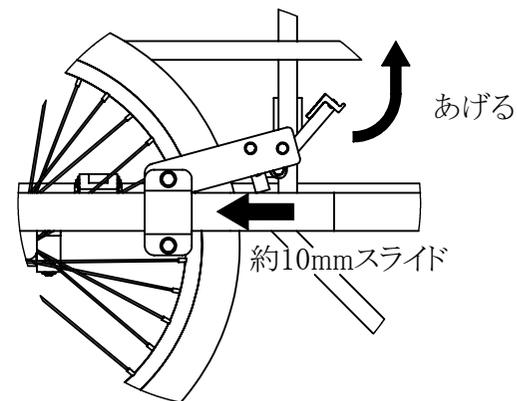
②ブレーキレバーを上にあげて、ロックを解除します。ヘムロックを矢印方向に約10mmスライドさせて固定します。
