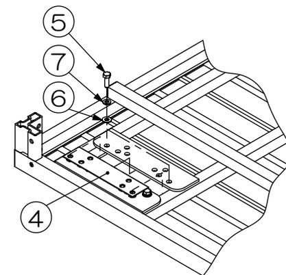
3. ④ナットプレートを①荷台フレームに取り付けます。
