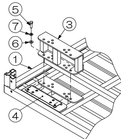
2. ③キャスターアダプターを①荷台フレームから取り外します。取り外す際、①荷台フレームの裏側に取り付いている④ナットプレートも取り外します。
