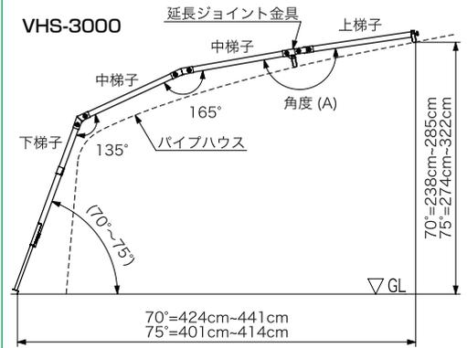
●角度(A)が自在で2本のコンタクトバーがハウスのアーチ形状に添って接地しますから安定します。
