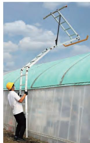
◀ VHS-3000は設置時や移動時は上梯子を手前にたて角度(A)を290°(左写真参照)に固定して、持ち上げる際のバランスをとります。(角度290°の保持と設置や撤収時に便利なベルト付です。)
