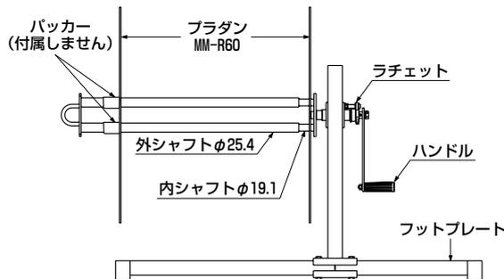
※プラダンはシート巻取用の補助具です。幅方向へ押されて広がる場合には手で押さえるかパッカー等で固定してください。(パッカーは付属しません。)
