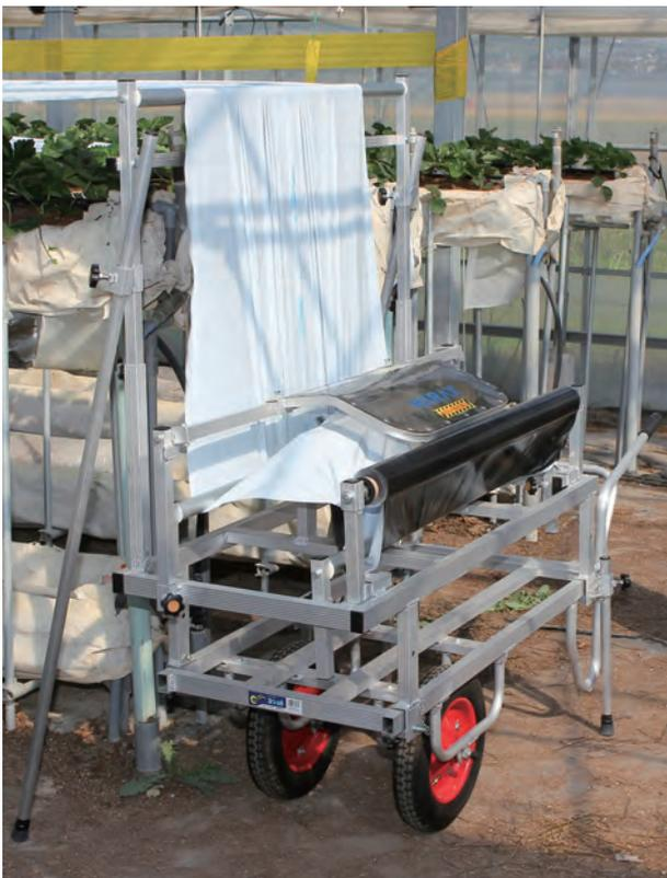
●本体を台車(コン助)の上に乗せ高くセットし、さらにガイドバーによりマルチを高く引き上げますから、いちごの高設栽培用としてご使用になれます。
