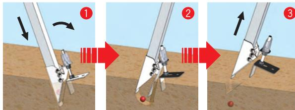
①歩きながらホッパに種を投入し、先端部を斜めに刺し込み、②進行方向に傾斜させると接地プレート作用で先端部が開き種が落ち、③そのまま抜くと先端部が閉じます。(①～③の繰り返し)
