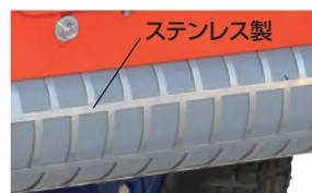
回転式散布量調節ロール (ステンレスの四角い溝付)
