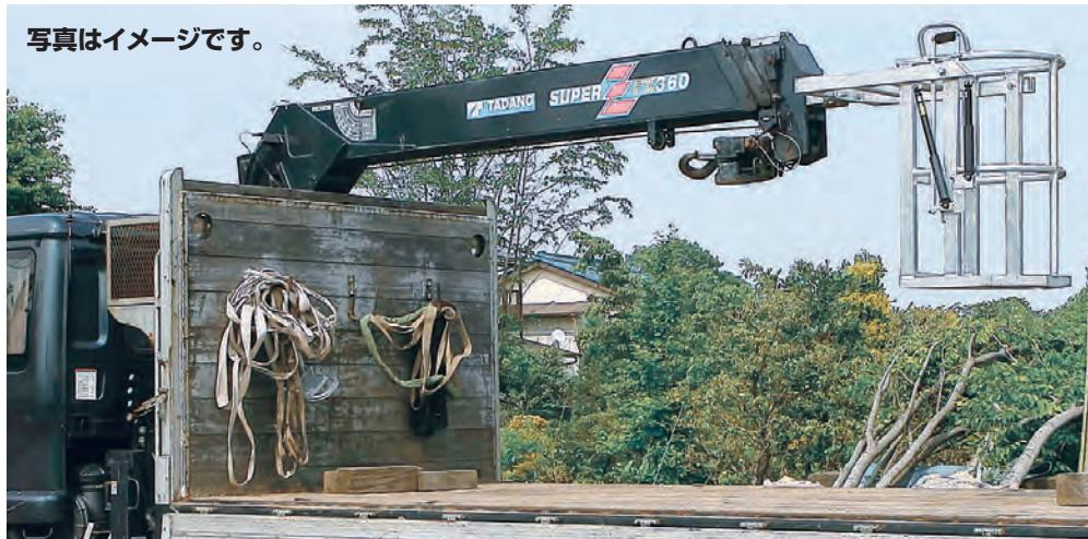
●フリーロック型ガススプリングは、アブソーバー式と比べ、ショックを吸収するだけでなく、長さを無段階にロックできる機構ですから、ワンタッチでゴンドラの角度を保持できます。
