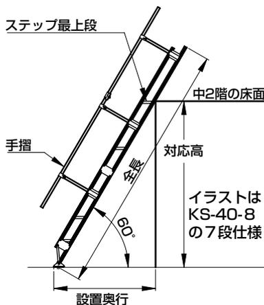
◎機種(型式)の選定は対応高を参考にしてください。なお、ステップ最上段が中2階の床面より高くないようご注意ください。
