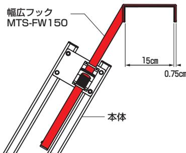
※マルチステップ全機種に取付け可能です。(既存のフックを取りはずしMTS-FW150を取付けてください。)
