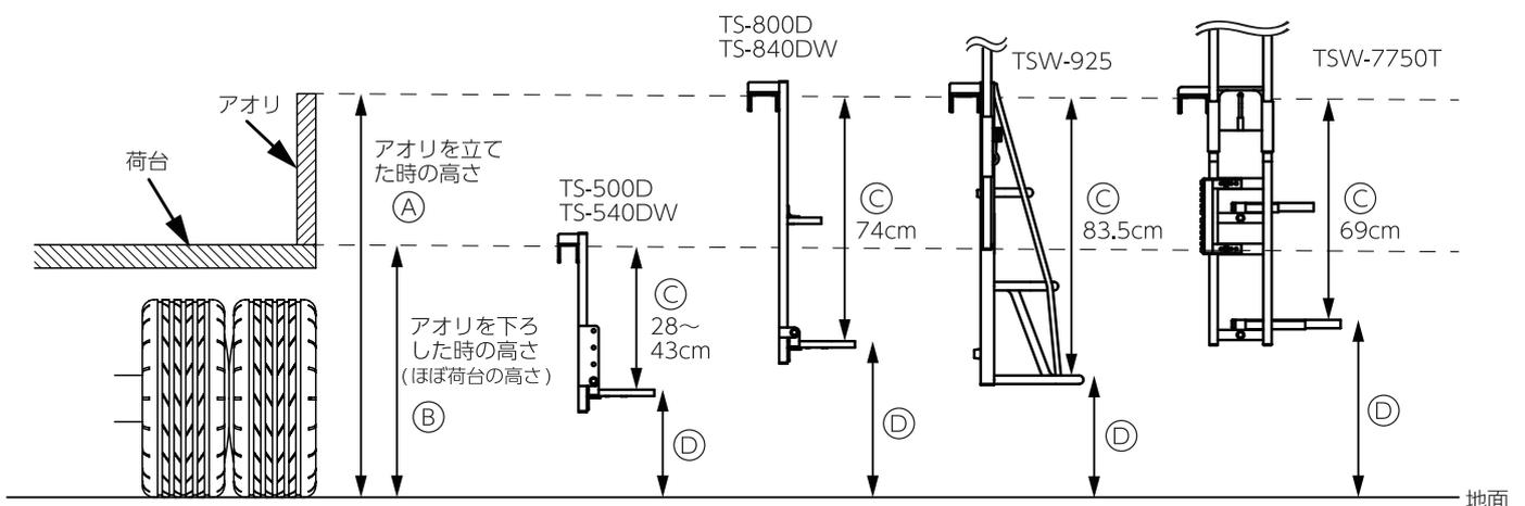
●高さの選定は、アオリの地面からの高さAまたはBを測り本体の有効長Cを差し引いた寸法がステップ最下段の地面からの高さDになります。
