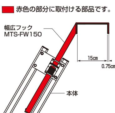
※マルチステッパ全機種に取付け可能です。（既存のフックを取りはずしMTS-FW150を取付けてください。）
