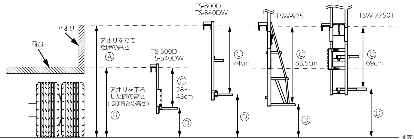
●高さの選定は、アオリの地面からの高さⒶまたはⒷを測り本体の有効長Ⓒを差し引いた寸法がステップ最下段の地面からの高さⒹになります。
